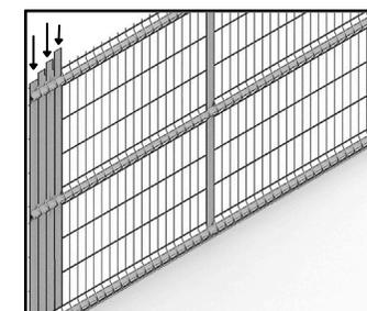
Glissez les lames d'occlusions dans chacune des mailles jusqu'au remplissage du panneau. Coincez les lames d'occlusions dans les profils de soutien.
