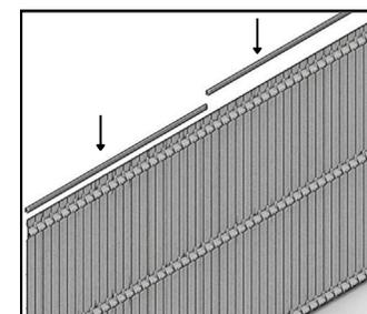
Clipser un à un les 2 profils de finition, côte à côte, sur le haut du panneau.
