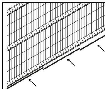
Clipser un à un les 3 profils de soutien, côte à côte, sur le fil du bas de la grille.
