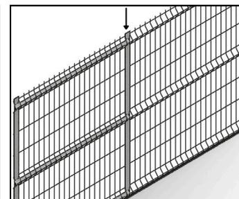
Glissez 1 lame d'occlusion au milieu de la grille pour bloquer les profils de renfort. Coincez la lame d'occlusion dans le profil de soutien.
