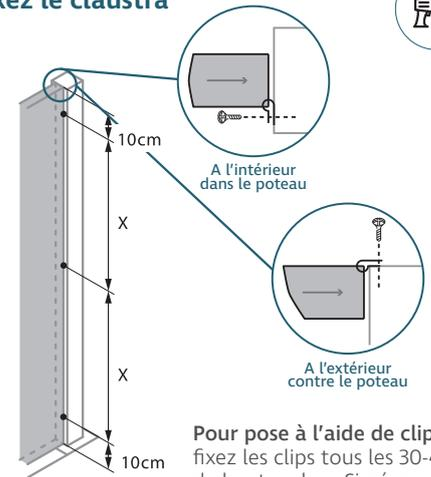
**Pour pose à l'aide de clips:** fixez les clips tous les 30-40cm de haut en bas. Si nécessaire, préforez à l'endroit de pose des clips d'attache.
