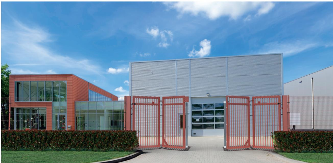
Le **Jet-Gate** est un portail double pivotant à ouverture rapide et durable. La vitesse d'ouverture/fermeture est comprise entre 300 et 1200mm/sec.
